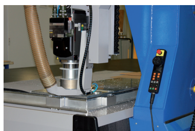
Elettromandri 25kW, coppia massima S1 : 24 mN
