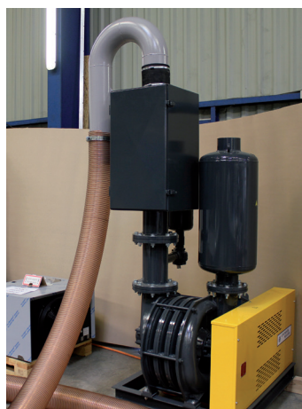
Piano aspirante con turbine multistadio
