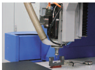
Mesure d'outil sans contact (diamètre et longueur)
