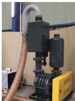
Turbine multi-étagée pour plateau à dépression
