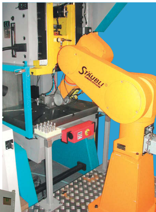
Presse 25 T avec chargement automatique robotisé
