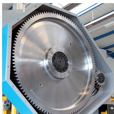
Вид шестерни малого зубчатого барабана 80Т в сборе
