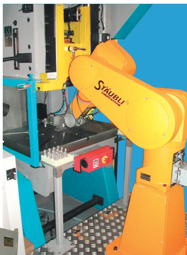
Пресс 25 тонн с автоматической роботизированной загрузкой
