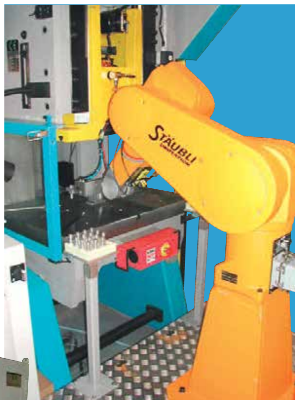
Prasa 25T z automatycznym zrobotyzowanym ładowaniem
