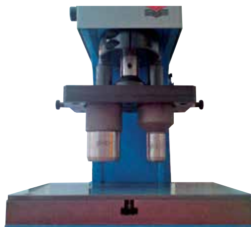
Prasa pneumatyczna z elektryczną skrzynką sterującą
