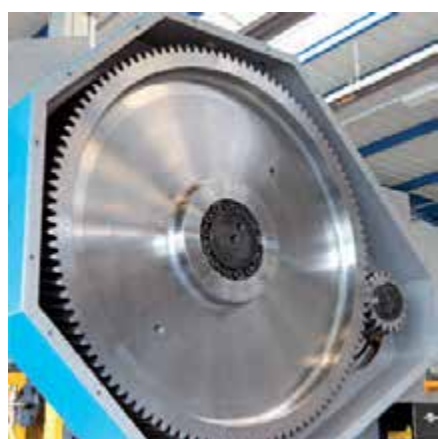
Widok na napędowe koło zębate prasy 80t
