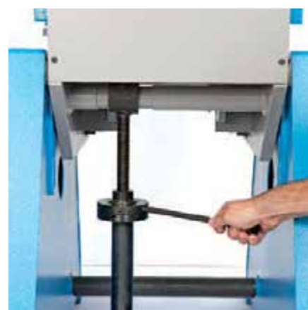
Nastawienie wychylenia (hydrauliczne dla 45 i 80T)
