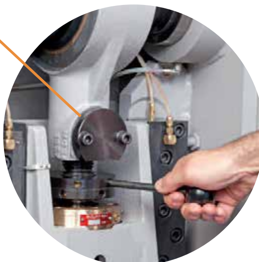
Szybkie nastawienie wysokości gabarytowej
