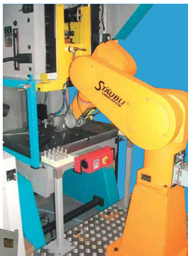
Presse 25 T avec chargement automatique robotisé
