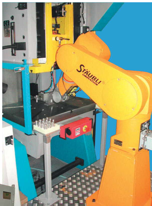
Presse 25 T avec chargement automatique robotisé
