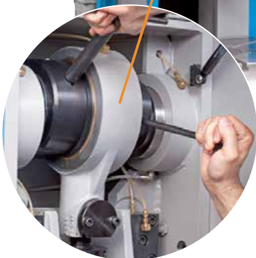
Ajuste rápido de la carrera
