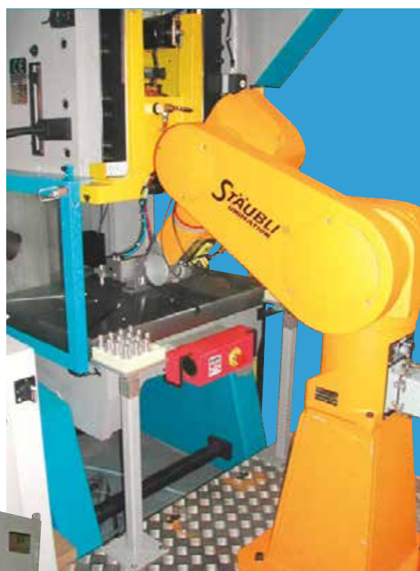
Prensa 25T con abastecimiento automático robotizado
