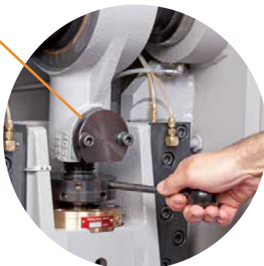
Быстрая регулировка свободного хода по высоте
