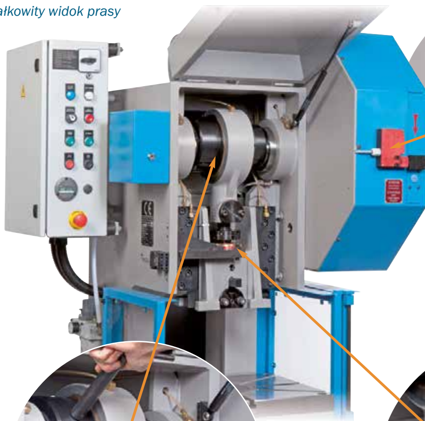
Nastawienie dolnego położenia bez motoru
