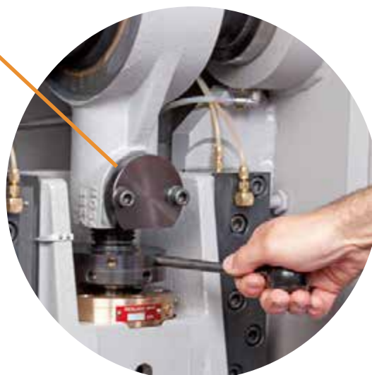
Szybkie nastawienie wysokości gabarytowej
