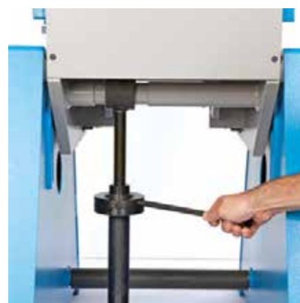
Nastawienie wychylenia (hydrauliczne dla 45 i 80t)
