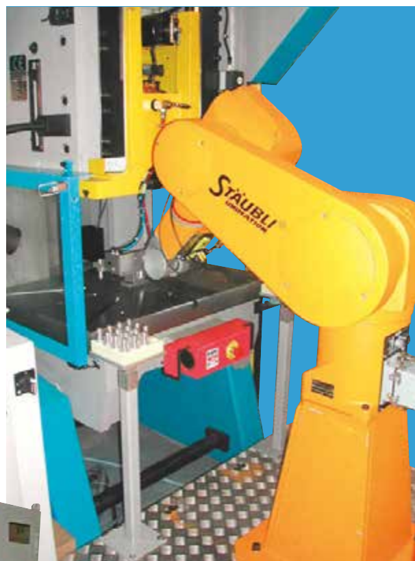
Prasa 25T z automatycznym zrobotyzowanym ładowaniem
