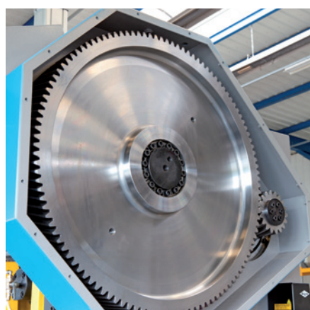
Widok na napędowe koło zębate prasy 80T
