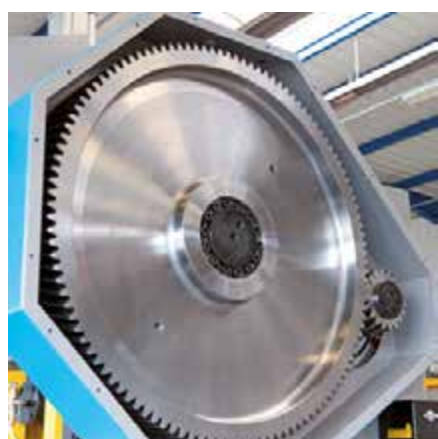
Vista del gruppo pignone ruota dentata dell'80t
