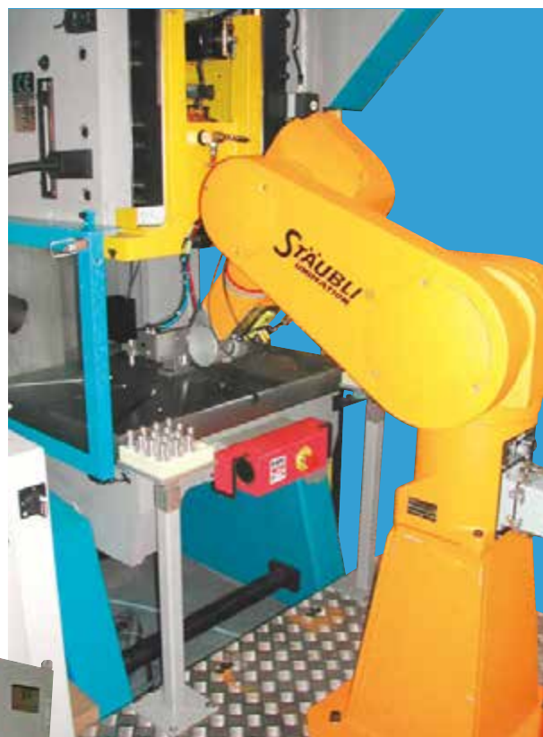
Presse 25 T avec chargement automatique robotisé
