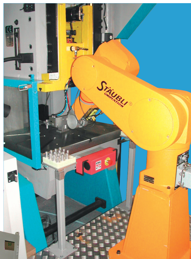
Presse 25 T avec chargement automatique robotisé
