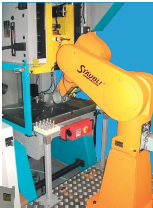
Prensa 25T con abastecimiento automático robotizado
