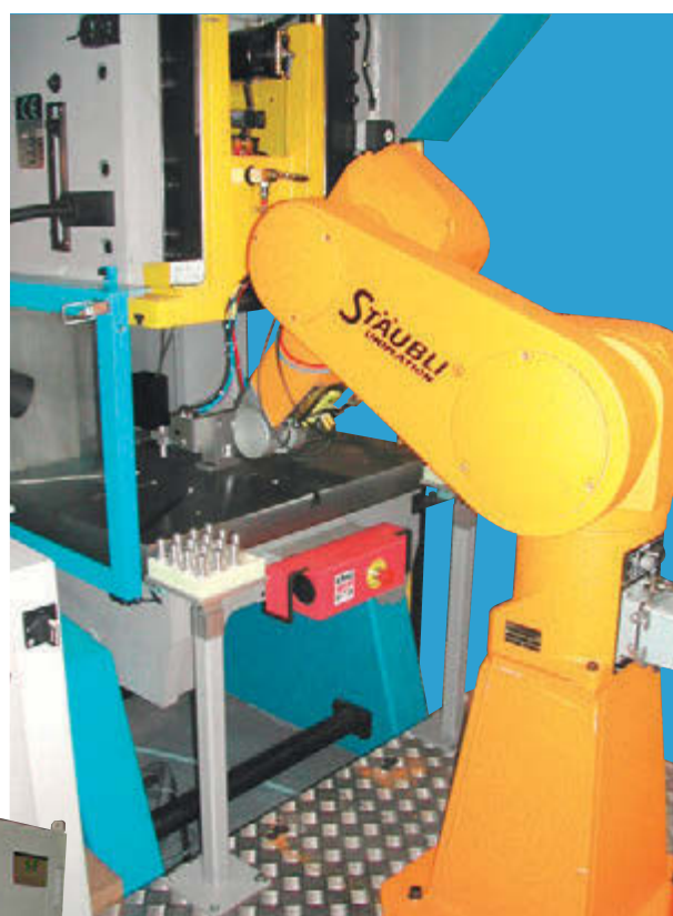
Presse 25 T avec chargement automatique robotisé
