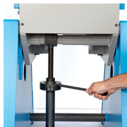
Réglage de l'inclinaison (hydraulique sur 45 et 80t)
