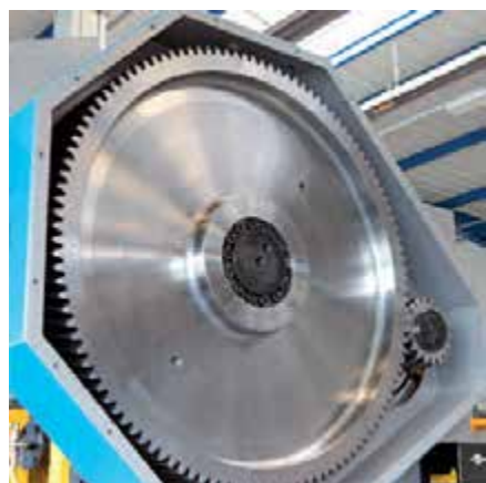
Vista del gruppo pignone ruota dentata dell'80t
