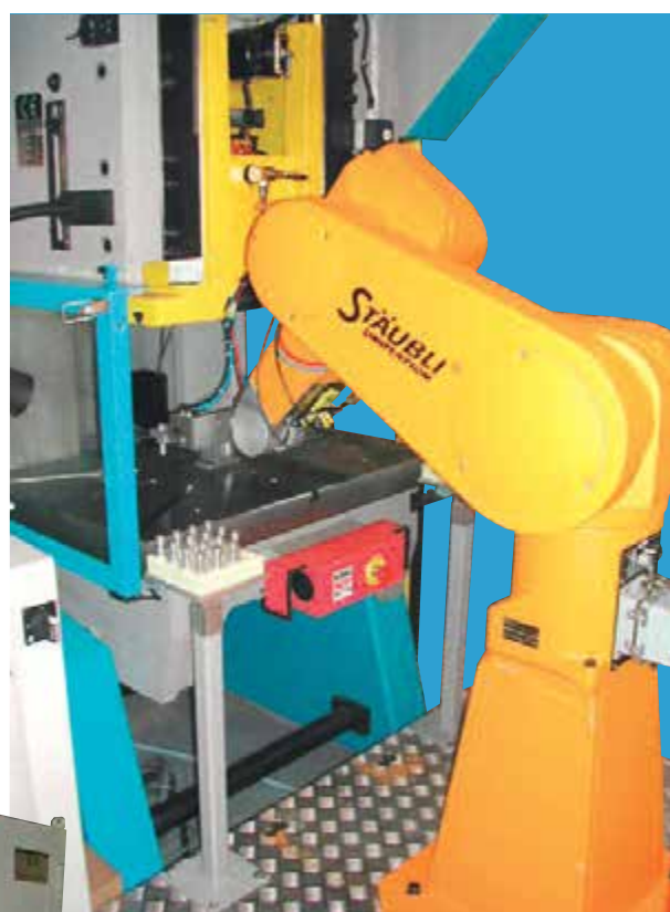
Pressa 25T con caricamento automatico robotizzato
