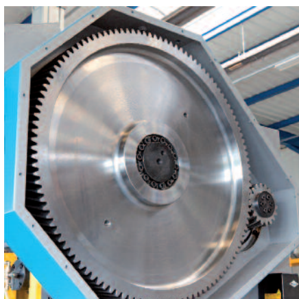
Vista del gruppo pignone ruota dentata dell'80t
