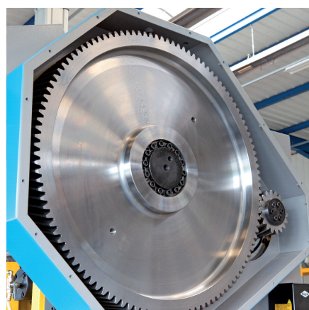
Vista del gruppo pignone ruota dentata dell'80t
