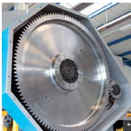
Vista del gruppo pignone ruota dentata dell'80t
