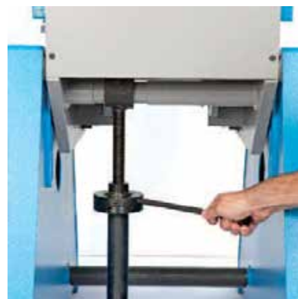
Regolazione dell'inclinazione (idraulica su 45 e 80t)
