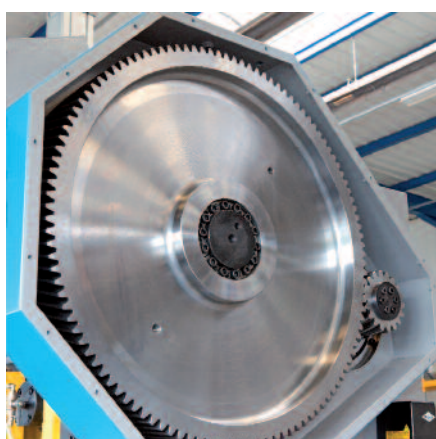
Vista del gruppo pignone ruota dentata dell'80t
