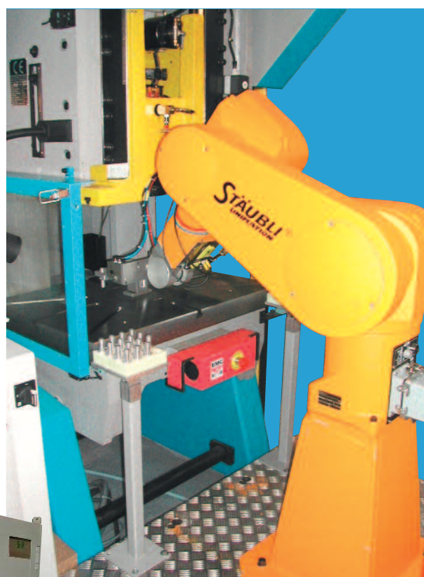
Pressa 25T con caricamento automatico robotizzato
