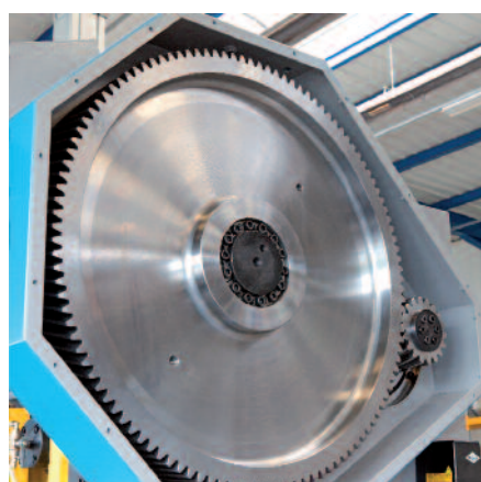
Vista del gruppo pignone ruota dentata dell'80t
