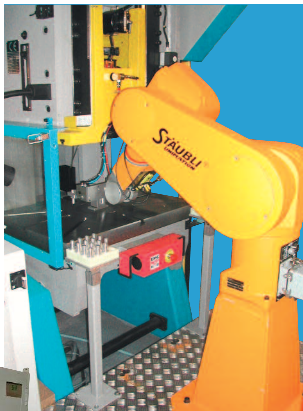
Pressa 25T con caricamento automatico robotizzato
