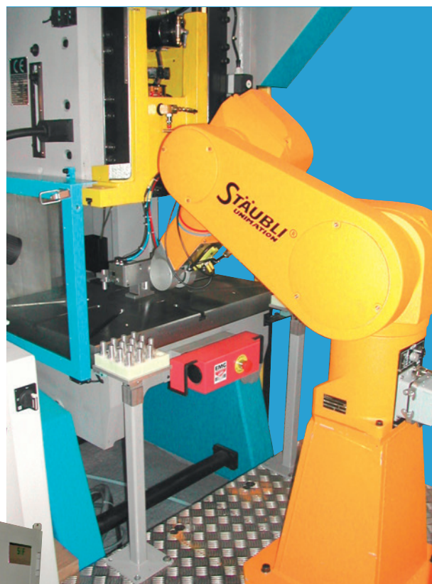
Пресс 25 тонн с автоматической роботизированной загрузкой
