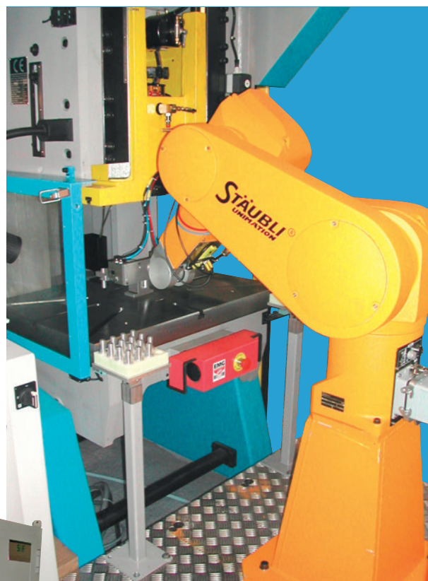
Пресс 25 тонн с автоматической роботизированной загрузкой
