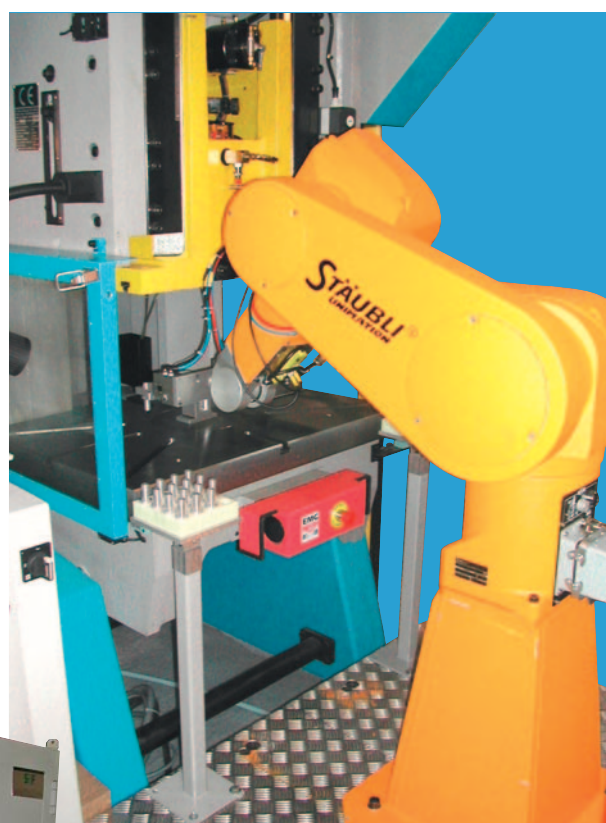
Presse 25 T avec chargement automatique robotisé
