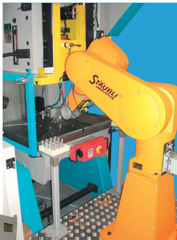
Prensa 25T con abastecimiento automático robotizado
