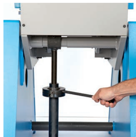
Ajuste de la inclinación (hidráulico en 45 y 80T)
