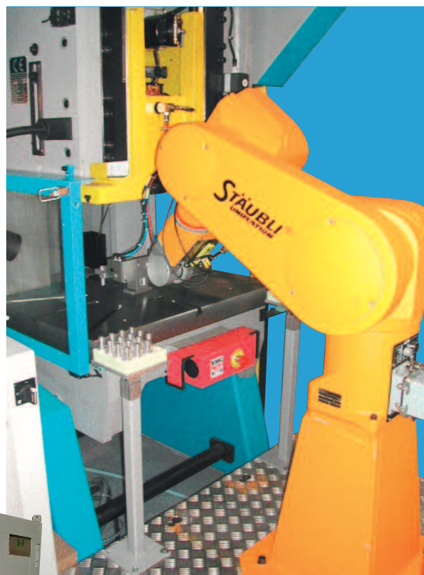
Presse 25 T avec chargement automatique robotisé
